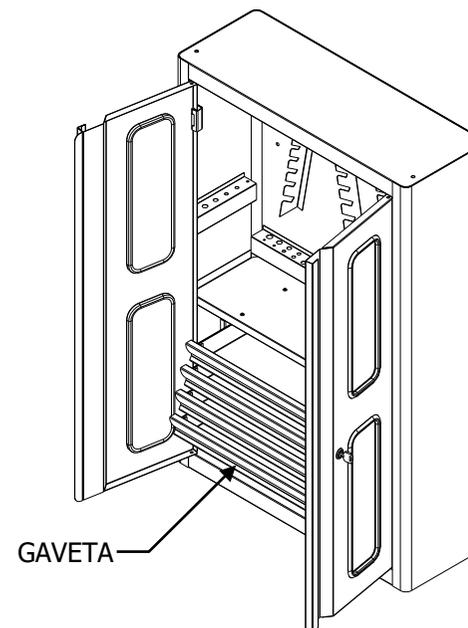
2. As gavetas possuem um sistema de deslizamento simples, sem o uso de corrediças telescópicas; as chapas laterais de apoio da gaveta deslizam diretamente sobre o trilho. As gavetas possuem uma capacidade de carga de até 20 kg distribuídos cada uma.
