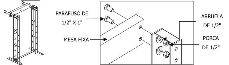
4. Parafuse o suporte do hidráulico.
