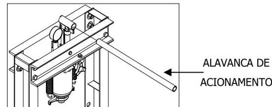
13. Depois de totalmente montada, fixe a prensa em piso regular e nivelado, utilizando nos furos das Cantoneiras lateral da coluna, chumbador parabol de 3/8" x 2 1/4". (Parabol não fornecido pelo fabricante).
