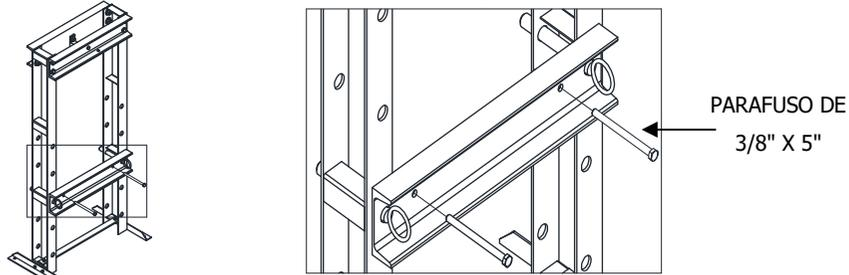
8. Posicione o tubo trava da mesa móvel conforme figuras abaixo.
