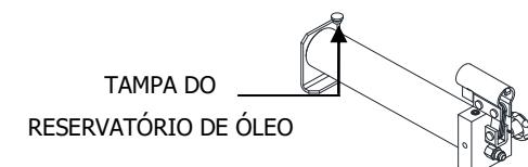
3. Deixe escorrer o óleo e inclua o novo na quantidade especificada na lista de peças da bomba hidráulica.
