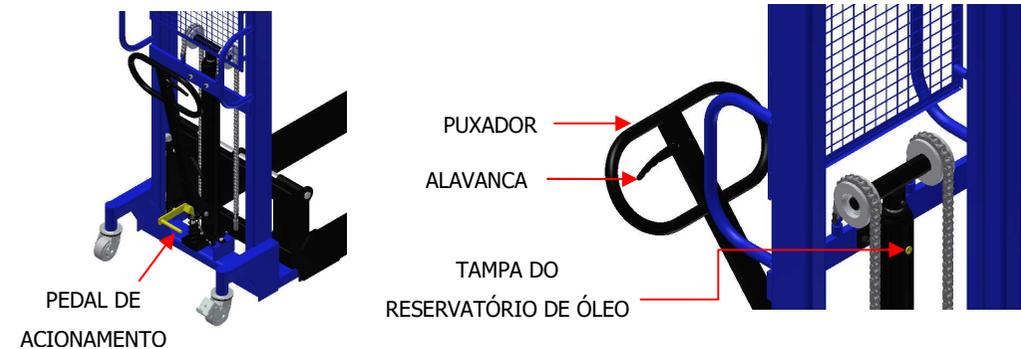
\*Obs.: As cores da tampa do reservatório e do pedal de acionamento foram modificadas na imagem para facilitar a visualização.
